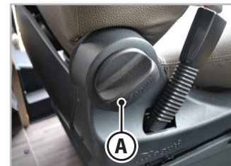
Fig.3.4 - Commande de réglage du dossier
