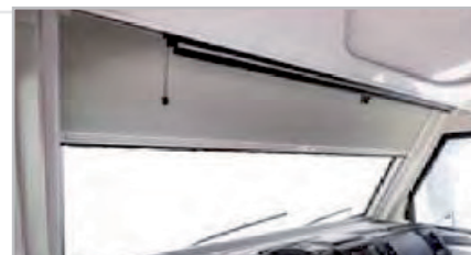
Fig. 6.17 - Positions du store occultant du pare-brise
